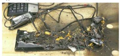
ノートパソコン用のバッテリーパック、の残骸。右側にある白くて丸い部分は、隣に置いてあった機器のゴム足の跡だ。右側に向かって激しく炎が吹き出したことが分かる。バッテリーパック内部の回路が故障した時、最悪、こうなる。自宅でコレは、本気で勘弁してほしい。別の写真もあるが、似たようなものだ。興味のある方は、インターネットで「リチウムイオン電池 爆発」で検索すれば、いくらでも出てくる。その他の種類の電池ならこうはならない、ということを示す写真は、残念ながら私の手元にはない。が、リチウムイオン電池が乾電池という形で普及しないのは、極端にアブナイというのが理由のようなので、およそ察しがつく。
